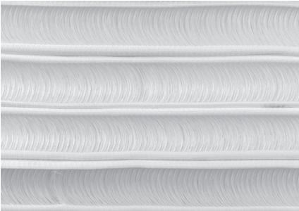
Spacer, de diseño tridimensional, realizado mediante la tecnología Raschel de doble frontura, con una distancia entre ellas de 13 mm. El número de mallas por centímetro es de 4 y los hilos utilizados son de poliéster de alta tenacidad.
